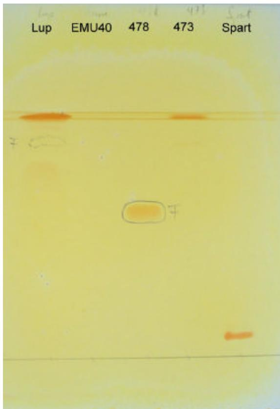
**Abb. 2 DC-Trennung von Lupinenalkaloiden**
